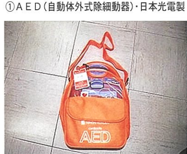
①AED(自動体外式除細動器)・日本光電製 心臓が痙攣(けいれん)し、血液を流すポンプ機能を失った状態(心室細動)になった心臓に対して、電気ショックを与え、正常なリズムに戻すための医療機器です。
